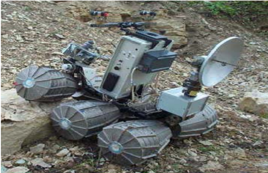
شکل ۲-۲: ربات برای زمین های ناهموار
