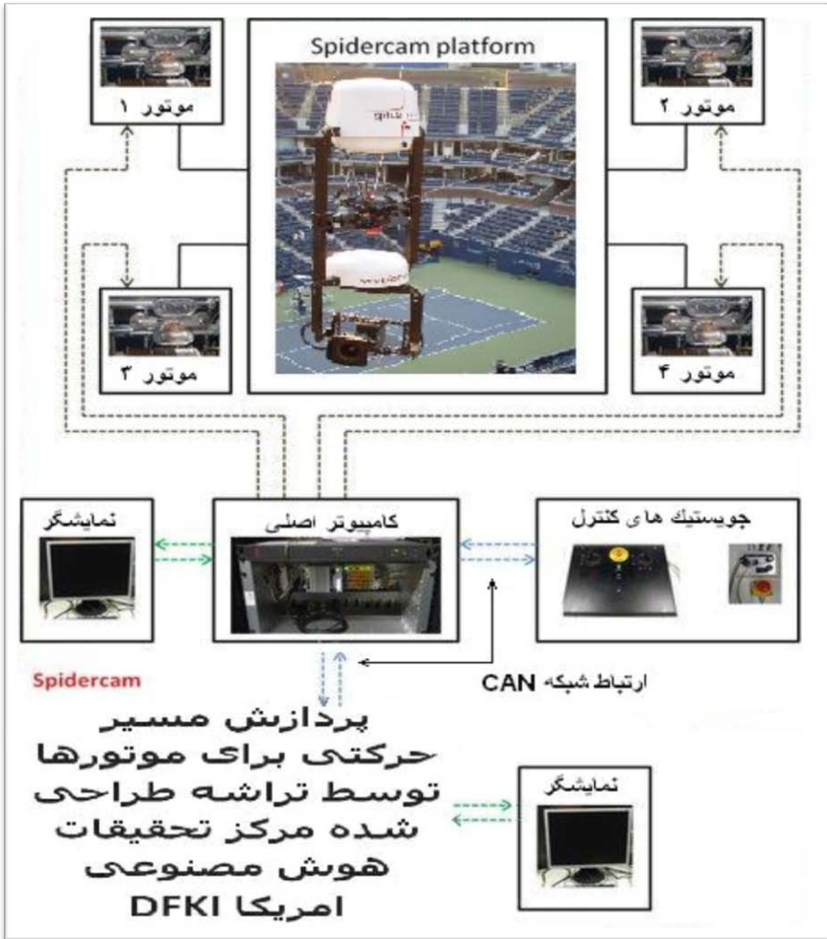
شکل (۱-۳) چارت ارتباطی بین اجزای مکانیزم اسپایدرکم
