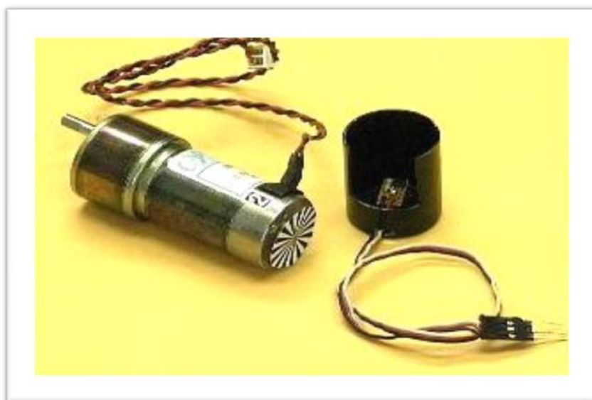
شکل (۲-۲۴) اتصال صفحه انکودر به محور موتور
