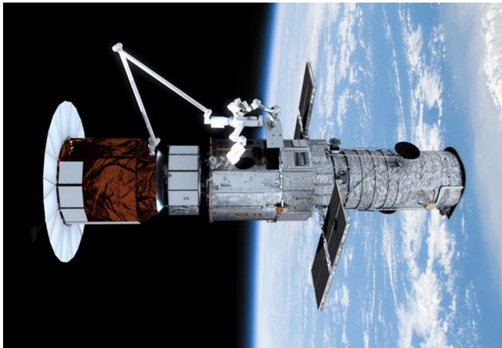
تصویر شماره 1-4 : بازو رباتیک در حال تعمیر تلسکوپ هابل
